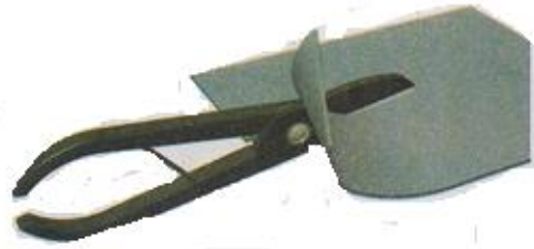
شکل ۱-۶- قیچی کاری ورق
